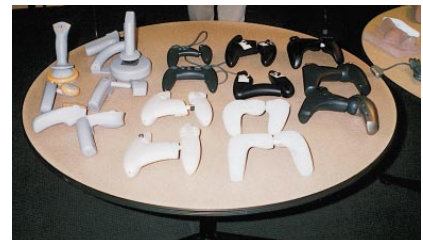
Bevor sich die Entwickler für das endgültige Aussehen eines Pads entscheiden, werden Dutzende funktionsunfähiger Modelle gebastelt.
